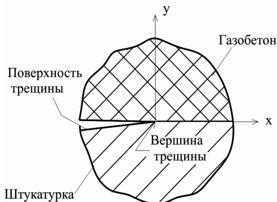
Рис. 5. Характер трещинообразования в контактной зоне «газобетонная кладка - штукатурное покрытие»
